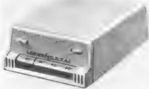
Bild 2. UHF-Konverter von Loewe-Opta
