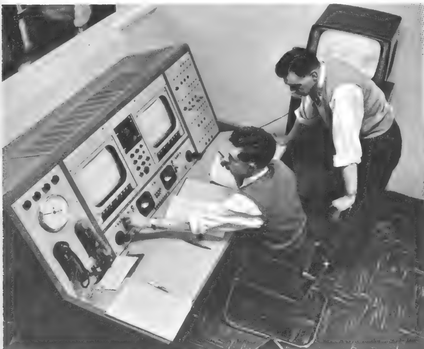
Bild 5. Kontrollpult des ITA-Fernsehenders Mendlesham/East Anglia. Die Anlage arbeitet in Kanal 11/Bereich III mit einer effektiven Leistung des Bildsenders von 200 kW
