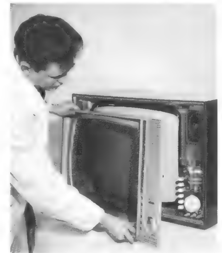
Bild 3. Die gesamte Frontabdeckung einschließlich Schutzscheibe läßt sich bei diesem Telefonen-Fernsehempfänger FE 251 T abnehmen
