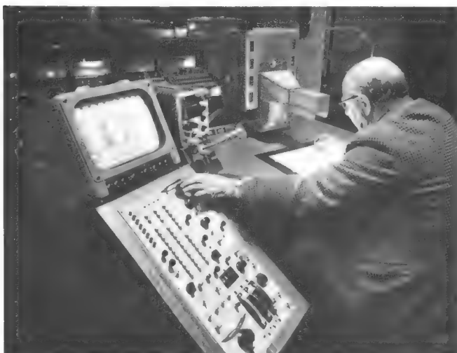
Bild 1. Großaufnahme des Trick-Mischpultes im neuen Studio 4 des Television Centre der BBC, London
