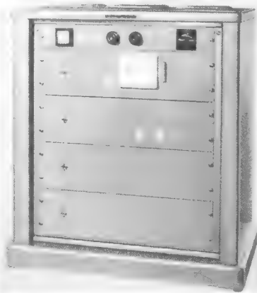
Bild 1. Sendezentrale der Telefunken-Personenrufanlage
