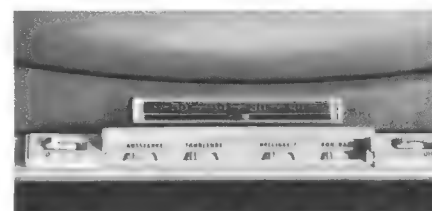
Bild 7. Bedienungsleiste mit UHF-Skala des Metz-Java und -Hawaii. Links Netzschalter, rechts VHF/UHF-Umschalter, in der Mitte, unter einer Klappe, die seltener zu bedienenden Einsteller für Lautstärke, Tonfärbung, Helligkeit und Kontrast
